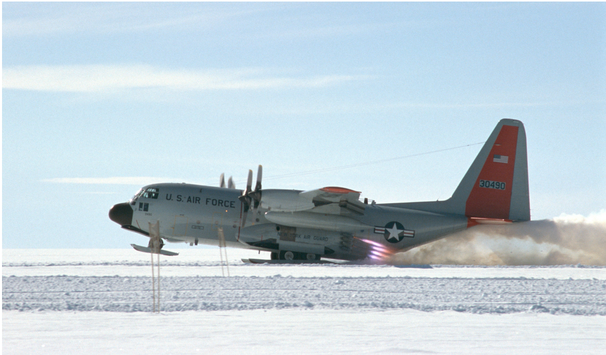
KUVA 12.1. Lockheed Hercules C-130 a nousee — suksilla! — Grönlannin NorthGRIP-jääkairausasemalta, joka sijaitsee kolme kilometriä merenpinnan yläpuolella. Huomaa JATO-raketit ( jet-assisted take-off ), jotka avustavat lentoon lähtöä kiitoradalta, joka on myös kolme kilometriä pitkä. Nielsen (2005).
