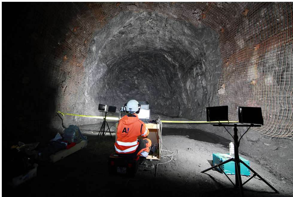
Kuva 1: Julkaisut 1 ja 4: LIBS tunneliskanneri Kittilän kaivoksella
