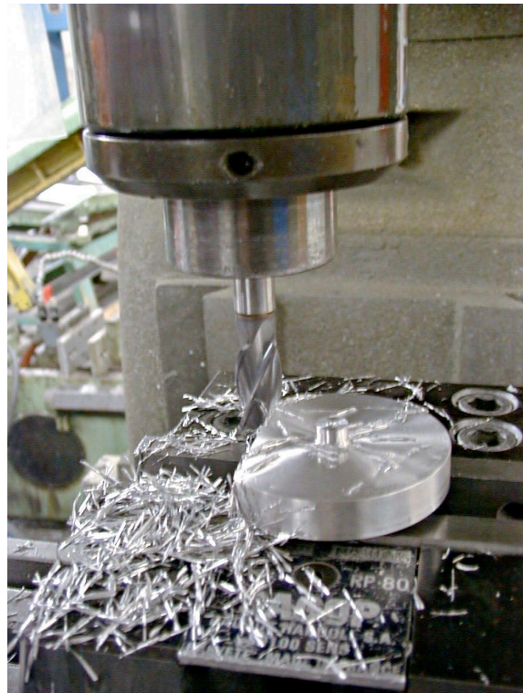
Lopullinen muotoilu tehdään jyrsimellä.
