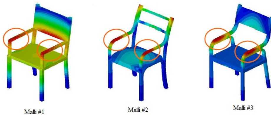
Kuva 23. Pudotusrasituksen aiheuttamat siirtymät (Laemlaksul 2008).
