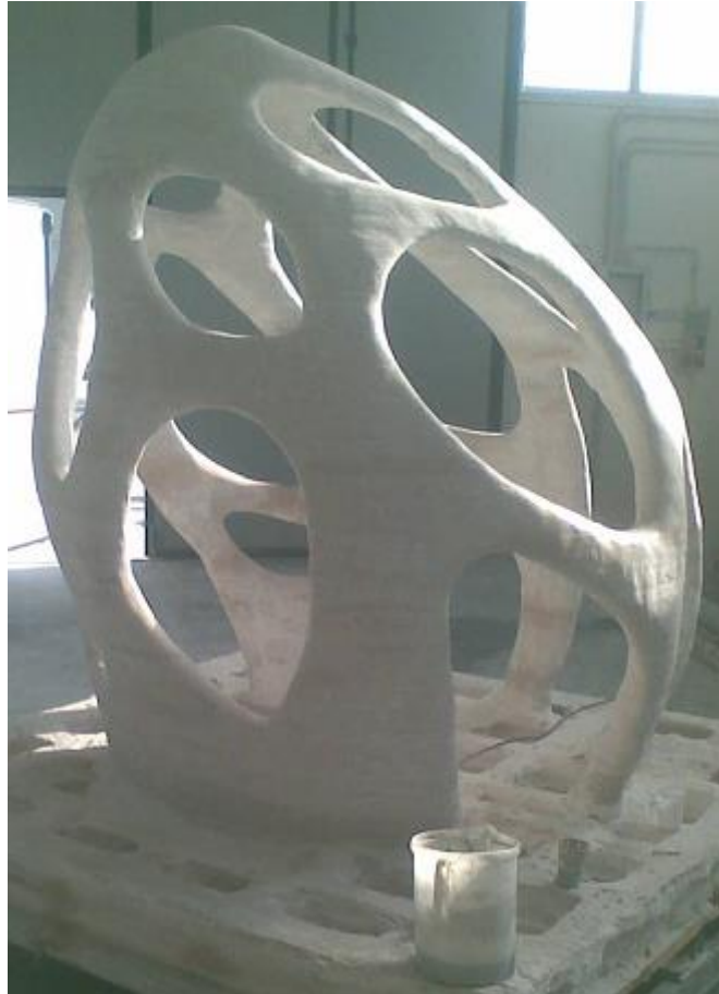
Kuva 9. D-Shapella tulostettu ”Radiolaria”-veistos. Sen korkeus on noin 3 metriä, mikä osoittaa, että D-Shape kykenee tulostamaan suuressa mittakaavassa. (D-Shapen verkkosivu)
